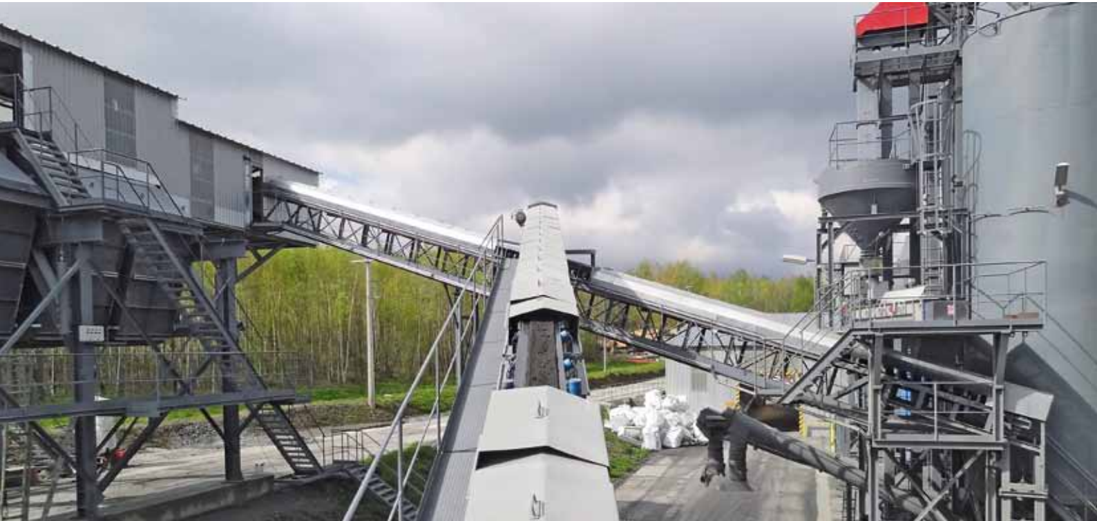
»1 New equipment for loading earth-moist slate flour in Jarnoltowek/Poland »1 Neue Anlage zur Verladung von erdfeuchtem Schiefermehl in Jarnoltowek/Polen
