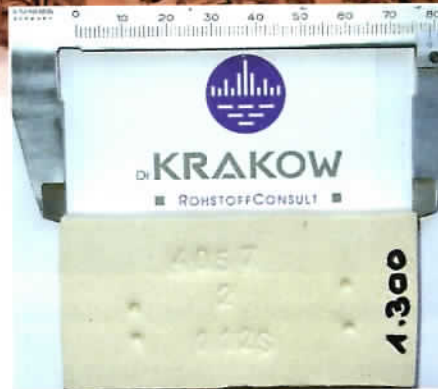
Zukunftsweisende Technik – Filterkuchen aus modernen Membranfilterpressen.
