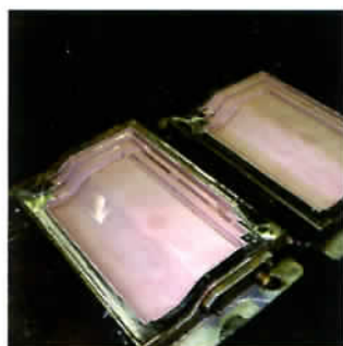
Filterkuchen vermindern den Abrieb an den sensiblen Gipsformen.
