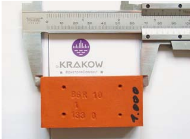
»7 Fired hand-moulded specimen »7 Gebrannter handgeformter Probekörper
