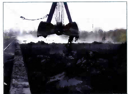
Bild 5 • Zwischenlager für Walzunderschlamm der Stahlindustrie
