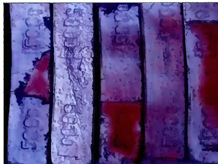
Bild 3 • Handstrichziegel mit Zugabe von 3 Gew.-% Eisenoxidgranulat
