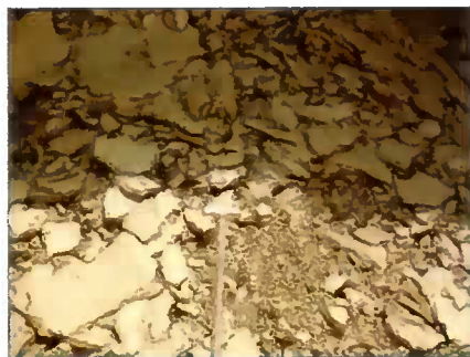
Bild 4 • Tonmineralischer Filterkuchen aus der Mineralwäsche
