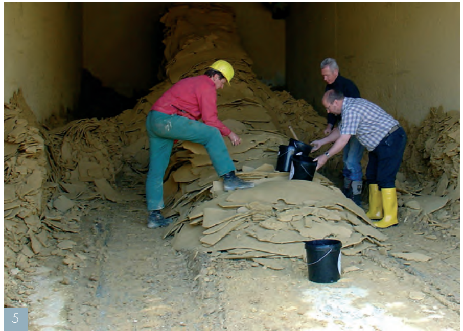
Filterkuchen mit idealer Konsistenz im Kieswerk Untschen/Deutschland
