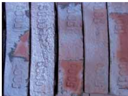
Bild 7 • ClayZero® – In Optik und Eigenschaften absolut gleichwertig (Handstrichverfahren, Reduktionsbrand im Tunnelofen bei 1120 °C)
