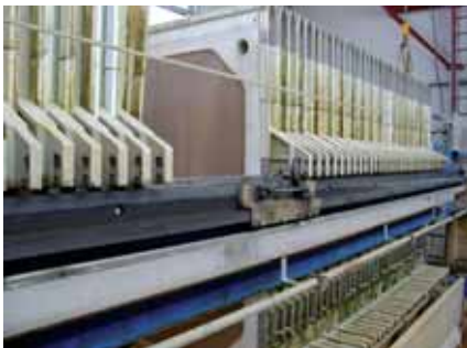
Bild 5 • Druckfiltration zur Fest-Flüssig-Trennung in einer Kammerfilterpresse
