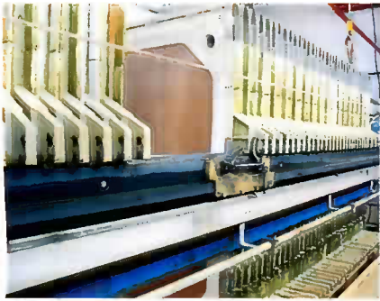
Druckfiltration zur Fest-Flüssig-Trennung in einer Kammerfilterpresse.
