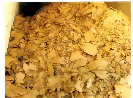
Der Stoff aus dem die neuen Ziegel sind. Filterkuchen sind hochwertige Sekundärrohstoffe und absolut frei von chemischen Schadstoffen.
