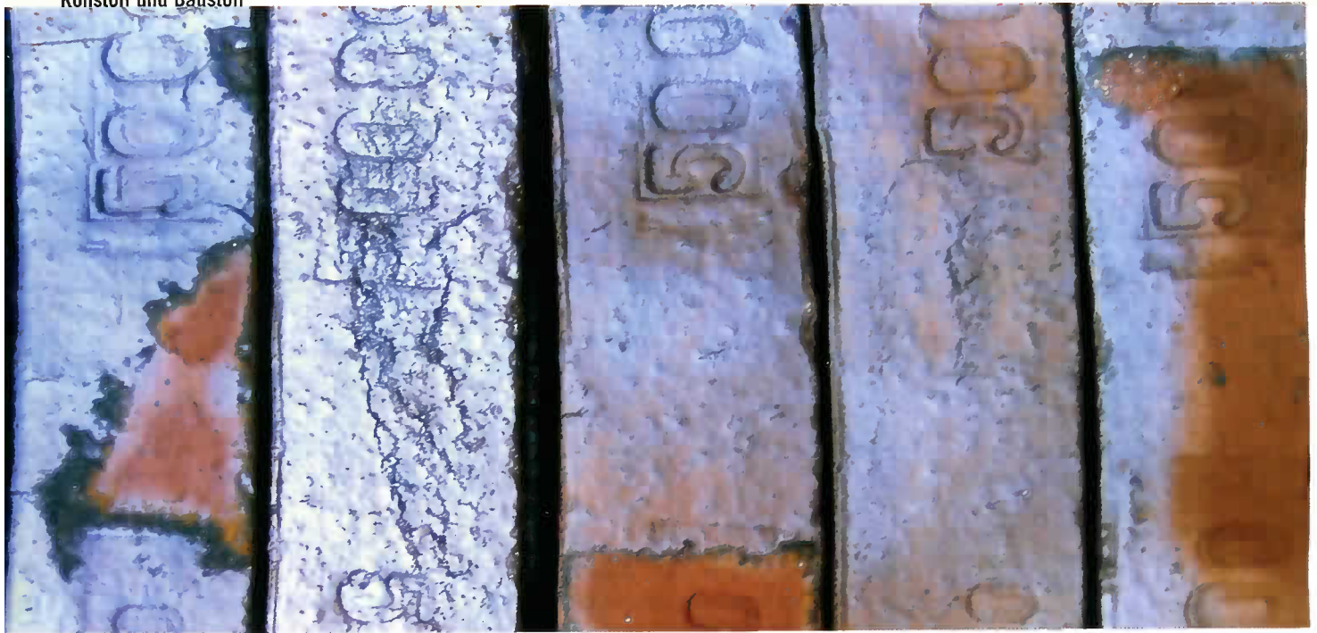
In Optik und bauphysikalischen Eigenschaften vom klassischen Ziegel nicht zu unterscheiden: ClayZero, der erste georessourcenfreie Ziegel.
