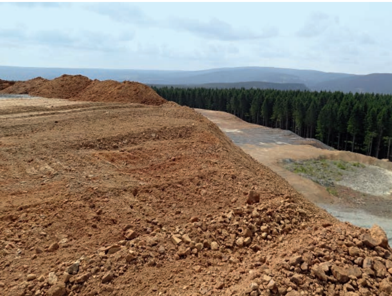
»4 Build-up of the raw clay stockpile in the vicinity of the quarry site »4 Aufbau der Rohtonhalde im Bereich des Steinbruchgeländes
